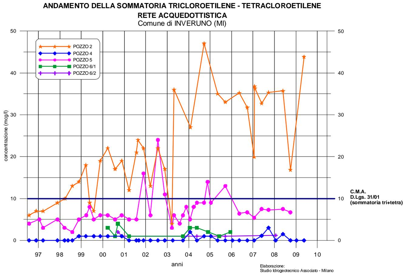
**Figura 5.3 – Andamento della sommatoria tricloroetilene - tetracloroetilene**
